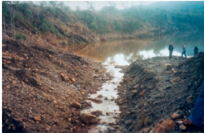
Foto 3 – Área na região carbonífera de Santa Catarina onde material estéril encontra-se em contato com águas superficiais contaminadas pela drenagem ácida.
